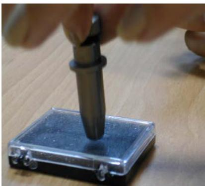
**Paso 3** Ajuste la punta de la cuchilla a la longitud adecuada girando el "tornillo de ajuste de la punta de la cuchilla" hacia la derecha o hacia la izquierda.
