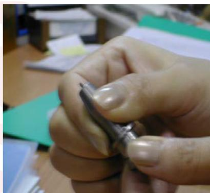
**Tip:** "La longitud adecuada" significa que la longitud de la hoja es aproximadamente 0,1 mm más que el espesor de la película. Por ejemplo, si el grosor de la película es de 0,5 mm, entonces la longitud de la hoja se ajusta correctamente a 0,6 mm y puede cortar completamente la capa de película sin cortar el respaldo del papel.
